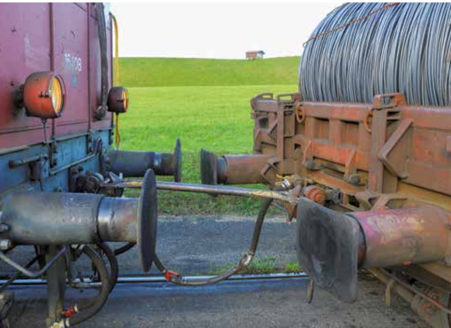
Gut zu erkennen: Kuppelstangen und die verlängerte Bremsleitung.
